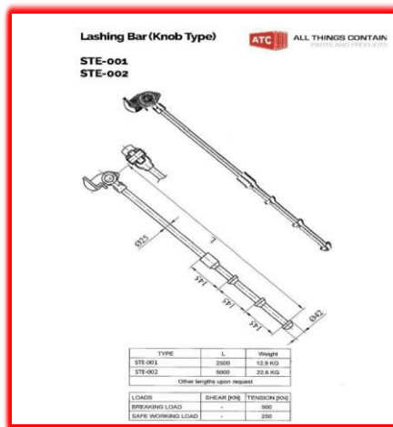
Figura 01 – Barra de amarração ( lashing bar ) curta (2,5 m – 12,9 kg) e barra de amarração longa (5 m – 22,60 kg)
